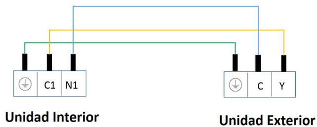
Figura 24. Diagrama de cableado de unidad exterior para sistemas B.Calor (208/230V/1F - 60Hz)
