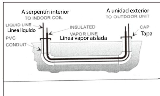
**Figura 7. Instalación típica**
