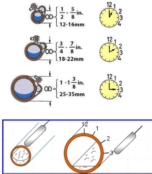
La posición correcta del bulbo remoto depende del diámetro exterior de la tubería de succión (siempre la de mayor diámetro). El bulbo nunca se debe instalar en la parte inferior de la tubería, debido a la potencial acumulación de aceite en este punto que puede generar una lectura incorrecta de la temperatura del refrigerante.
