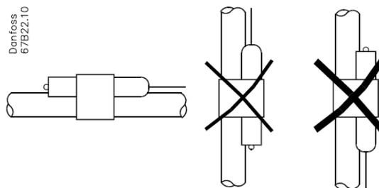
El bulbo debe instalarse en posición horizontal. Si ésto no fuera posible, y la única opción de instalación resulta ser vertical, se recomienda instalar el bulbo con la salida del capilar hacia arriba.
