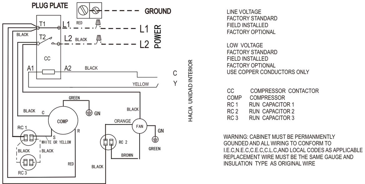
Figura 23. Diagrama de cableado de control para sistemas A/C
