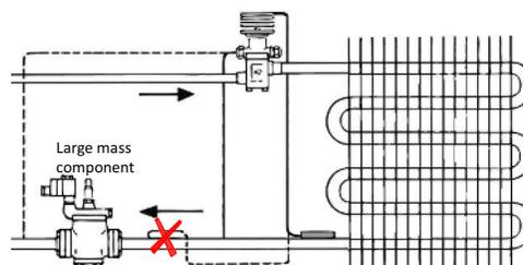
**Figura 17. Montaje del bulbo con una grampa/abrazadera**
